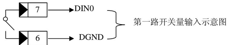
第一路开关量输入接的是一个开关，开关的一端接第 7 脚 (DIN0)，另一端接第 6 脚 (DGND)。
