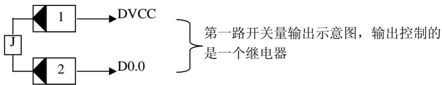
第一路开关量输出控制的是一个外部继电器（继电器的线圈是 12VDC），继电器线圈的其中一脚接仪表接线端的第 1 脚 (DVCC)，继电器线圈的另一脚接仪表接线端的第 2 脚 (D0.0)。
